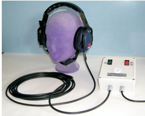
Der Fernsprecher mit Schallschutzkopfhörer ist als Telefon konzipiert, das von einer 24 V - Stromversorgung betrieben werden kann (Zentralbatteriebetrieb). Durch Drücken des Tasters wird das Rufsignal am Schaltgehäuse ausgelöst.
